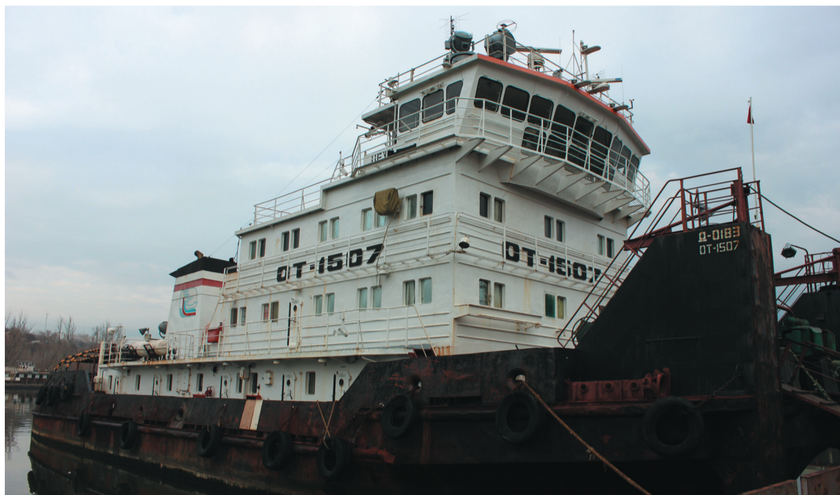
«ОТ-1507» — толкач-буксир мощностью 1120 кВт. Длина судна составляет 41,5 м, ширина — 13 м, высота борта — 3,8 м. Водоизмещение теплохода в грузу составляет 768 тонн при осадке в 2,52 м. Судовладелец — ОАО «Донречфлот» (входит в Азово-Донское пароходство). Порт приписки — Калач-на-Дону.
